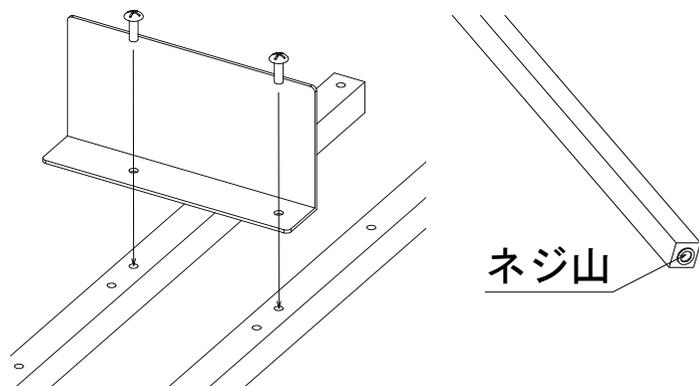
2、②台座に①フレームを⑥M8 六角穴ボルトで取り付ける
